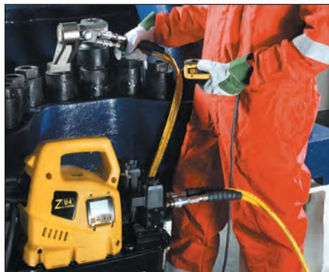
◀ Cualquier marca de llave de torque hidráulica puede ser accionada por las bombas para llaves de torque de la serie ZU4.
