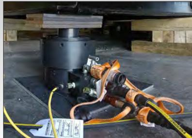
◀ Cilindros personalizados con contratuerca y de doble acción, con sensores internos de carrera y una válvula de sujeción de carga integrada para la elevación de componentes nucleares.
