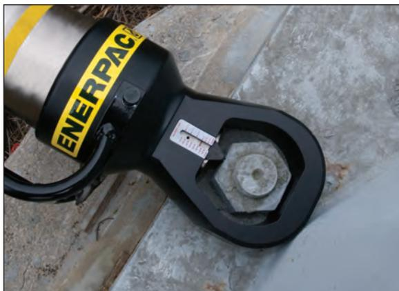
◀ Las tuercas muy corroídas y gastadas pueden cortarse y retirarse rápidamente utilizando un cortador de tuercas de la Serie NS.
