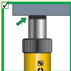
◀ No utilice el cilindro sin la silleta. De lo contrario, se deformará el émbolo. Las silletas del cilindro distribuyen la carga en forma uniforme sobre todo el émbolo.
