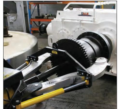
▲ El EPH-1002 extrae rápida y fácilmente este acoplamiento motriz de su eje.
