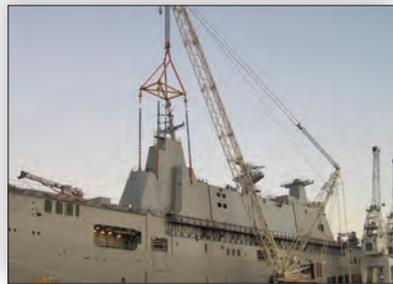
Elevación y colocación sincrónicas de carga
