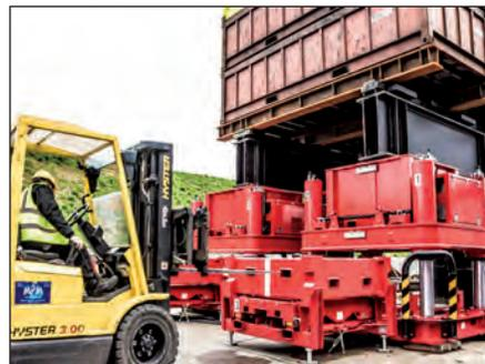
▼ Se usó un sistema SyncHoist para alinear bloques de acero de las secciones de la torre de control del buque para permitir la elevación y el posicionamiento graduales de la carga.
