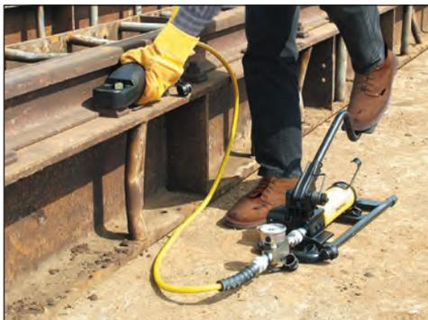
◀ La extracción fácil de tuercas herrumbrosas durante trabajos en ferrocarriles es solamente uno de los muchos ejemplos de aplicaciones del cortador de tuercas Enerpac.
