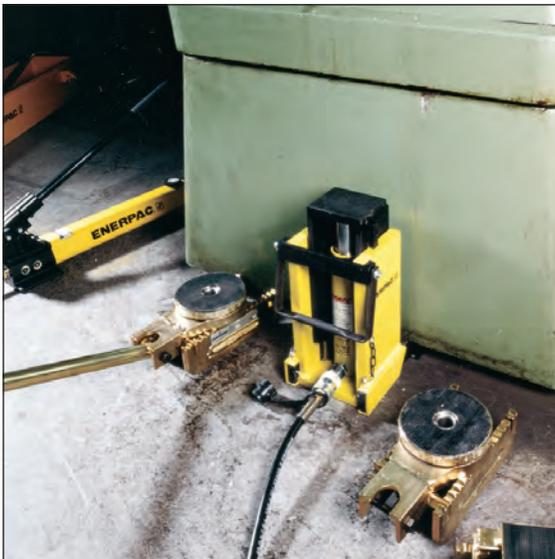
▼ Transporte de tanque para productos químicos: Para las primeras pulgadas la carga se elevó con un cilindro de baja altura de la serie RCS y luego se movió a patines de carga para su transportación.
