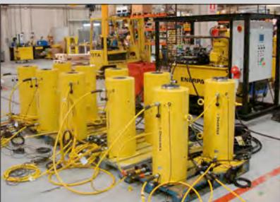
◀ Cilindros personalizados con sensores integrados para la construcción de puentes.
