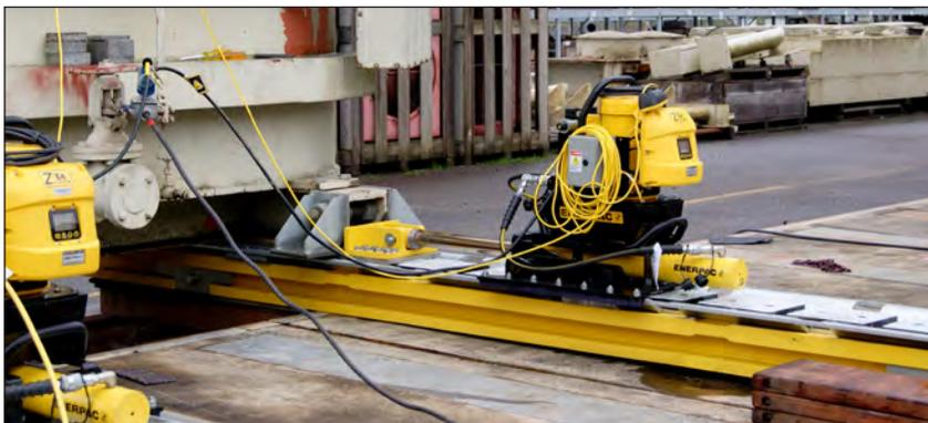
▼ *Gato para zapata de deslizamiento HSKJ-1250.*
