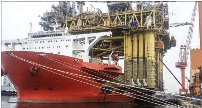
▲ El super levante y botadura al agua de un sistema flotante de producción de petróleo de 43,000 toneladas en Malasia para el yacimiento mar afuera Gumusut-Kakap ha establecido altos estándares en cuanto a seguridad mediante el uso de sofisticados sistemas hidráulicos síncronos de la serie EVO para elevar, equilibrar, pesar y botar al agua fácilmente gigantescas estructuras de recursos.
