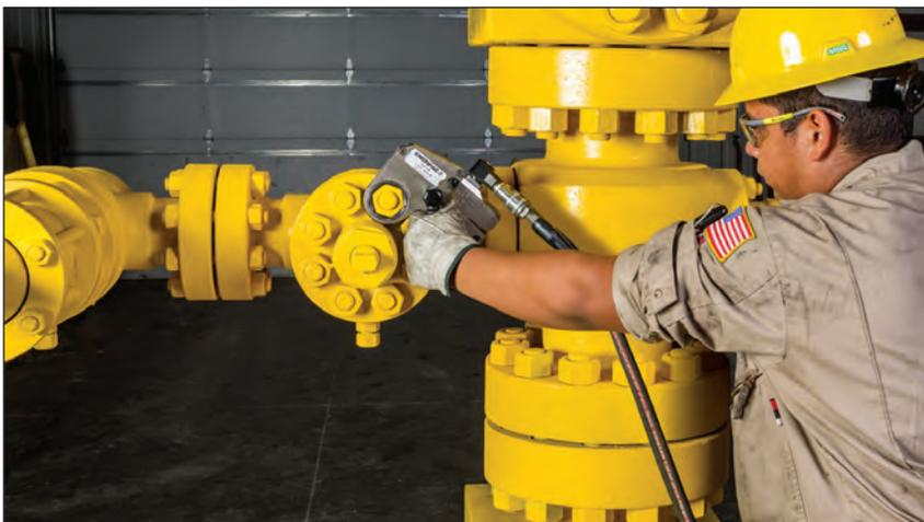
◀ *La mayoría de las llaves de torque hidráulicas pueden accionarse mediante la bomba para llaves de torque Enerpac de la serie ZA4.*
